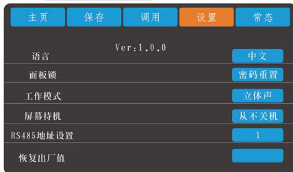
设置：中英文、面板锁定、工作模式、屏幕待机、RS485地址设置、恢复出厂值
